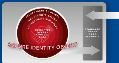
Основываясь на успехе флагманской технологии iCLASS для смарт-карт 13,56 МГц (и бесконтактной технологии HID 125 кГц Prox), новая платформа управления доступом от HID Global выходит за рамки традиционной модели смарт-карт, предлагая надежную, стандартизированную, независимую от технологий и гибкую структуру идентификационных данных на основе Secure Identity Object (SIO), новой портируемой модели идентификатора от компании HID.
