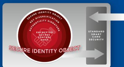
Основываясь на успехе флагманской технологии iCLASS для смарт-карт 13,56 МГц, новая платформа управления доступом от HID Global выходит за рамки традиционной модели смарт-карт, предлагая надежную, стандартизированную, независимую от технологий и гибкую структуру идентификационных данных на основе Secure Identity Object (SIO), новую портируемую модель идентификатора от компании HID.
